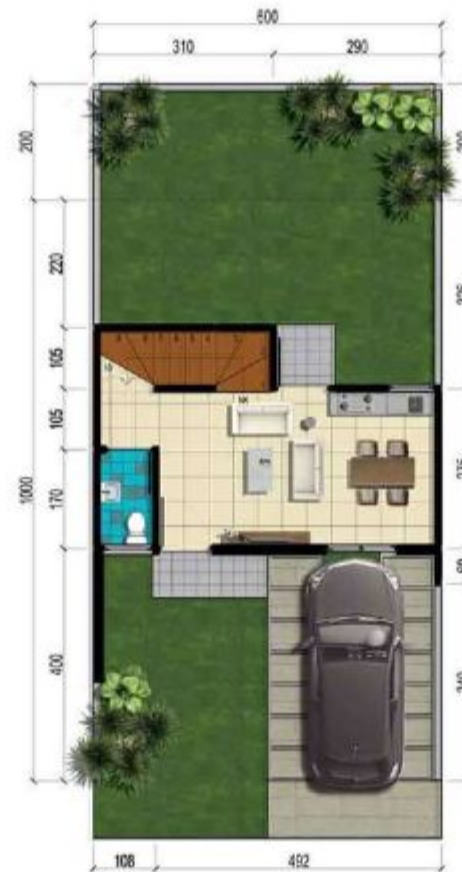
Tipe 47 DENAH LANTAI 1 SKALA 1 : 100
