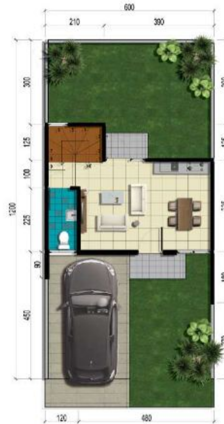
Tipe 57 DENAH LANTAI 1 SKALA 1 : 100
